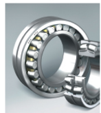
NSK-PS-Fundrollenlager sind wartungsarm bis zu 200 Grad Celsius und geeignet für hohe Drehmomente und hohe Drehzahlen. Sie sind auch für extreme Stoß- und Momentenlasten geeignet.
